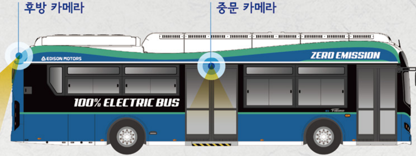
서브 디스플레이 7inch LCD Display / 탑승객 안전을 위한 상시 중문, 후방 카메라뷰
